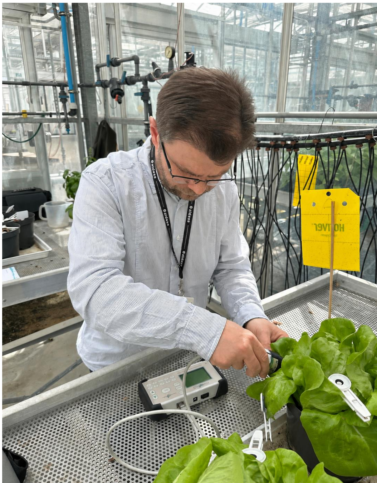
Załącznik 1. Fotografia prezentująca wykonanie pomiarów fluorescencji chlorofilu a na sałacie (fot. H. Kalaji)
