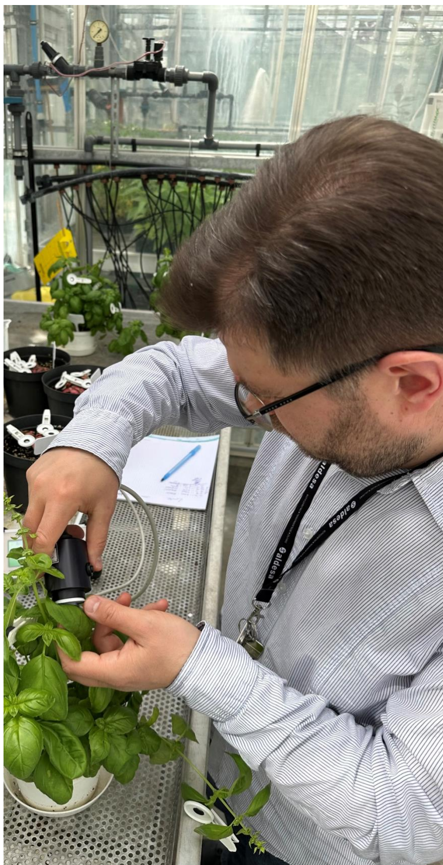
Załącznik 2. Fotografia prezentująca wykonanie pomiarów fluorescencji chlorofilu a na bazylii (fot. H. Kalaji)
